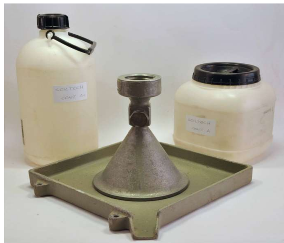
Piastra, cono, boccione per la sabbia e boccione per il campione
